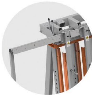
Magazin (an der Seite) für unbenutzte Flächenpresseeinheiten
